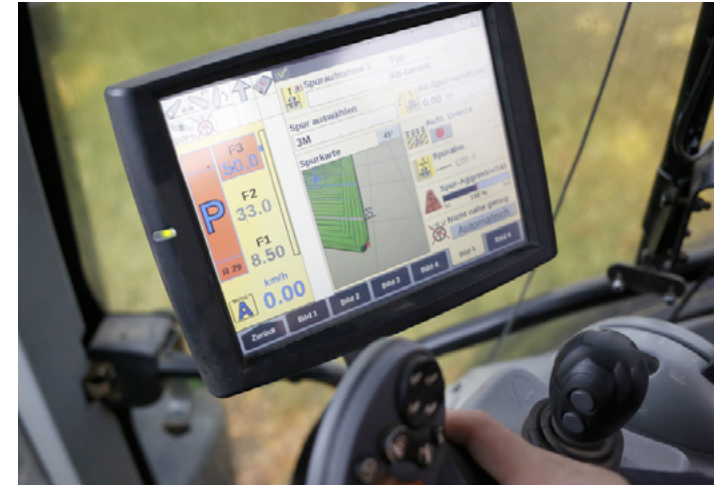
Abb. 8: Ausführliche Ansicht der Spurkarte und -details durch das RTK-Lenkensystem auf dem Schlepper von Georg Thoma (Foto: Carmen Westermeier).
