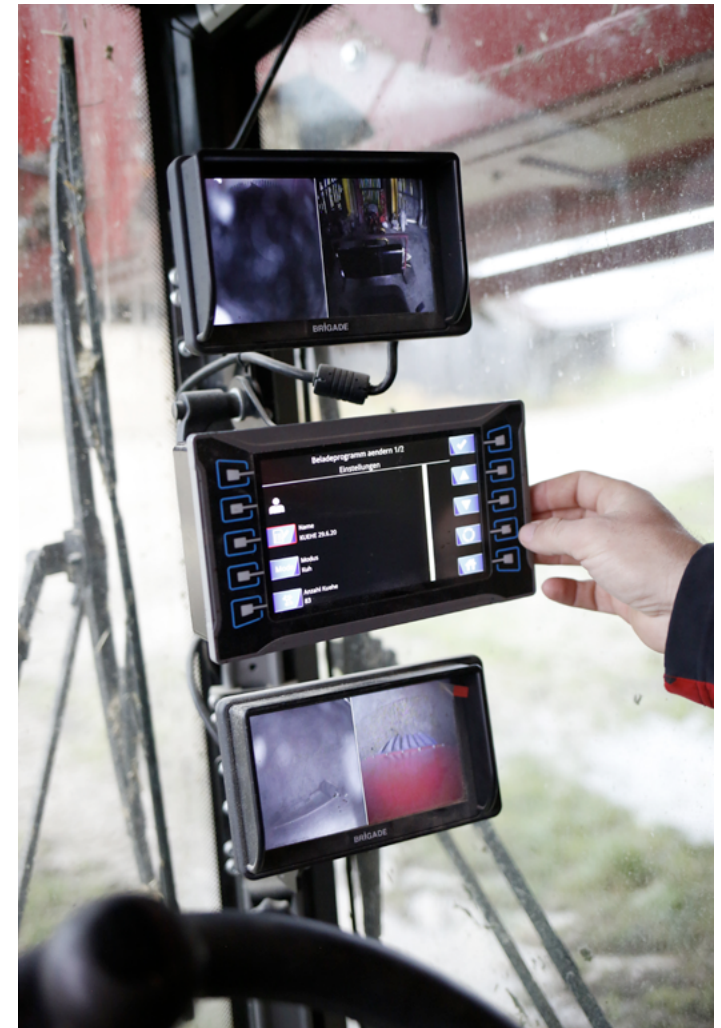
Abb. 5, Auf dem Futtermischwagen Siloking hat Familie Thoma vier Rückfahrkameras zur Sicherheit für Mensch und Tier verbaut. (Foto: Carmen Westermeier).
